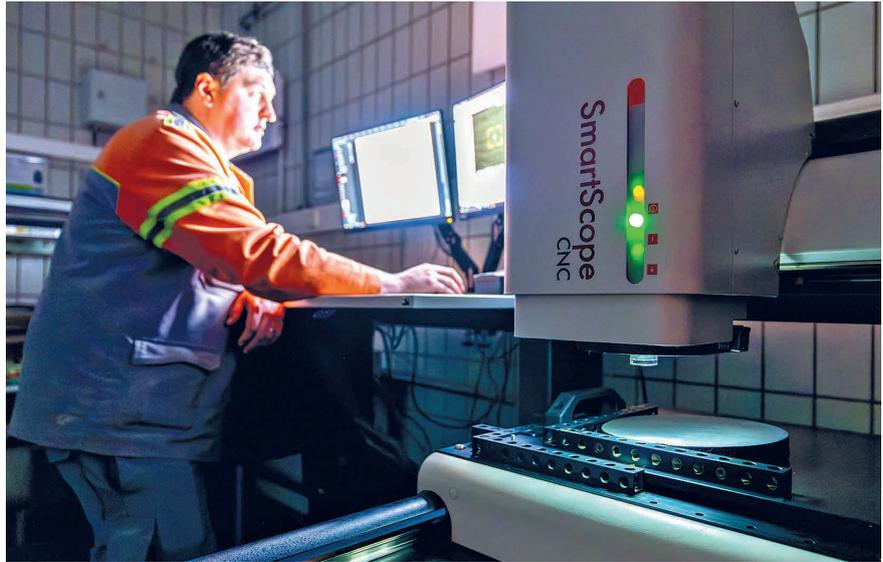
Für die neue Messmaschine wurde eigens ein Raum eingerichtet, in dem es sauberer und temperaturstabiler zugeht als draußen im Stahlwerk.
