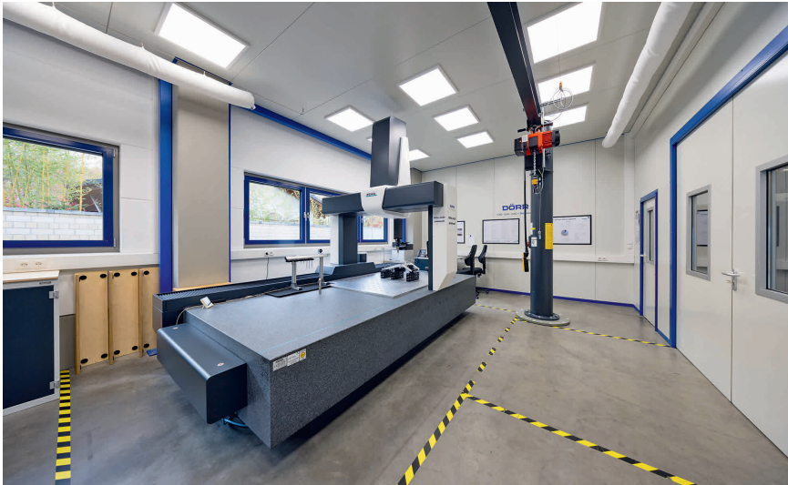
Der neue Messraum wurde bewusst größer dimensioniert, um Bauteile vor der Messung 24 bis 48 Stunden temperieren zu können – ein kritischer Faktor bei großen Stahl- oder Gusskomponenten. Daher auch ein Kran im Raum. © Mike Koenig Photography
