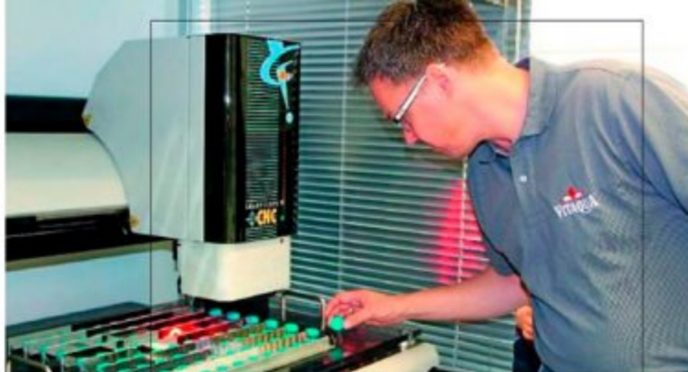
Harald Hefer, Leiter Verschlussproduktion bei Vitaqua, vor dem SmartScope CNC 500 von OGP. 80 Verschlüsse misst es optisch in einer Zeit von rund 90 min. Bilder: Quality Engineering
