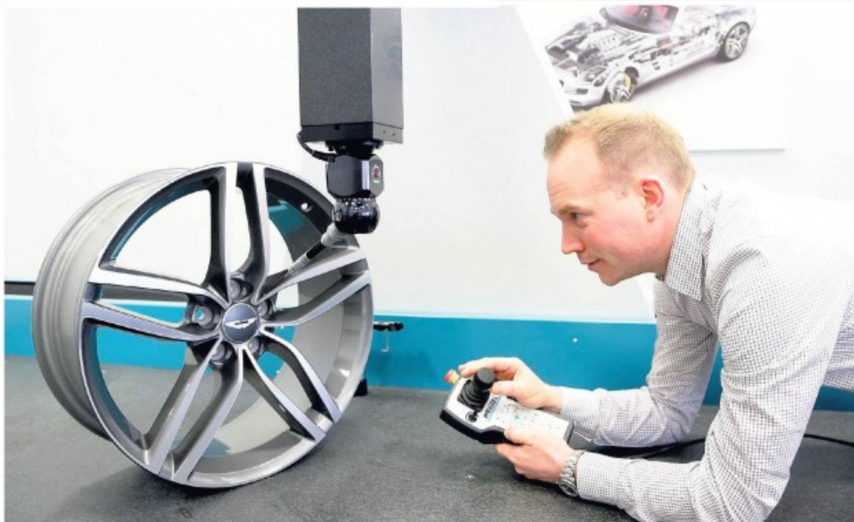
Winzige Teile für die Medizintechnik, handfeste Felgen oder auch Lkw-Teile bis zu einem Gewicht von zwei Tonnen kann Christian Klostermann mit seinen Spezialgeräten exakt vermessen. Fotos (2): Roland Keusch
