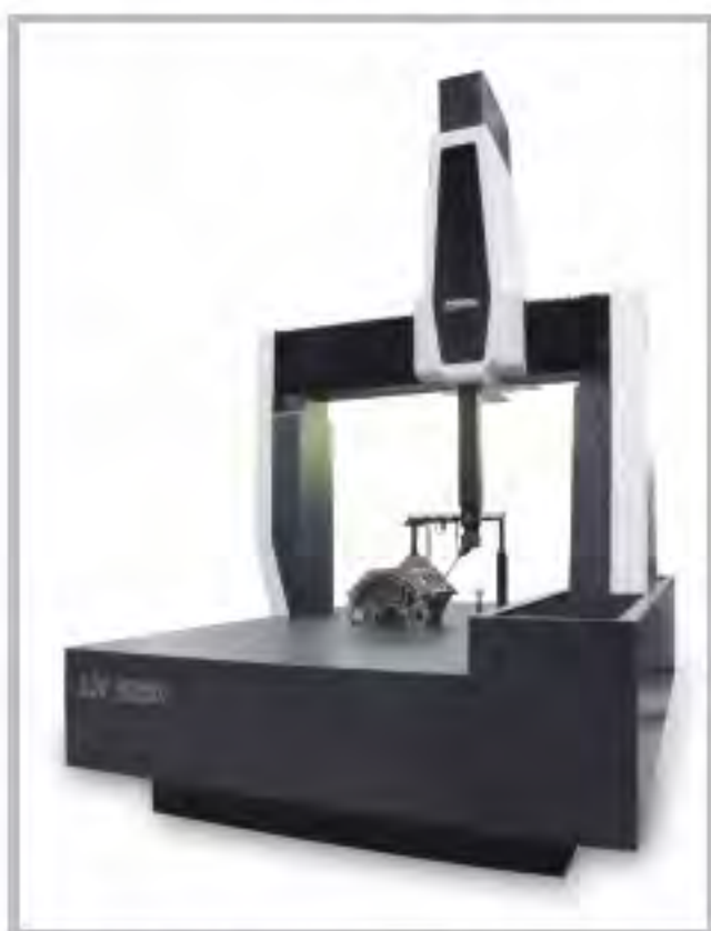
Bild 2. Das CNC-Portal-messgerät für schaltende, messende und optische sowie indexierte Tastsysteme nimmt ganze Motorblöcke auf. (© Foto: Wenzel)
